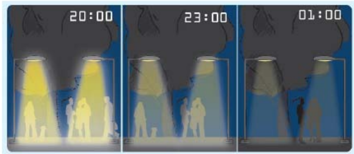
Abbildung: Beispiel für eine gute Lichtabstrahlung und Reduktion der Leuchtdauer (StMUV 2020)
